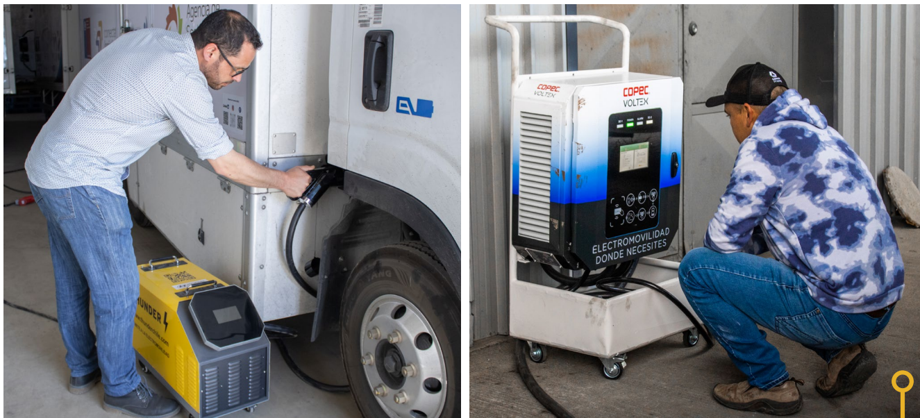
En las imágenes se observa el uso de cargadores portátiles para cargar eléctricamente los vehículos
